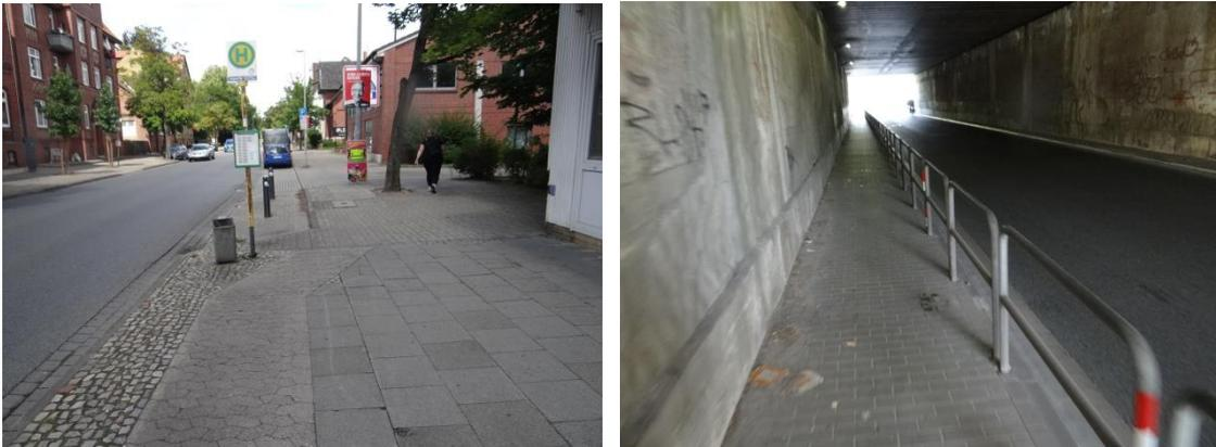
Bei der Seitenraum-Führung stören Höhenversätze an Einmündungen (Abbildung 48), Verschwenkungen sowie Schilderpfosten und Gegenstände (Abbildung 47). In der nördlichen Hambrocker Straße entstehen Konflikte mit dem ruhenden Kfz-Verkehr, da hier die Parkbuchten mit ca. 1,40 m sehr schmal sind und Kfz regelmäßig den nicht beschilderten Radweg zum Parken mitbenutzen (Abbildung 48).
